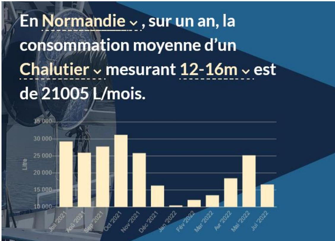
Figure 3 : Suivi de la consommation mensuelle moyenne de gasoil pêche d'un chalutier normand mesurant entre 12 et 16 mètres, entre juillet 2021 et juin 2022. © Observatoire du carburant AMARREE.
